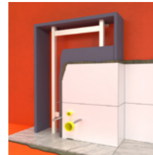
BILD O – Tätskikt bakom inbyggd WC Tätskikt ska finnas på golv och vägg bakom den inbyggda spolcisternen. Klinker på golv ska finnas under inbyggnaden. Kontrollera med tätskiktsleverantören om eventuell keramik bakom spolcisternen.
