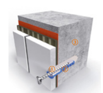
BILD R – Infästning i betongvägg Skruv ska botten i betongen. 1. Tätmassa 2. Plugg och tätmassa 3. Betongvägg
