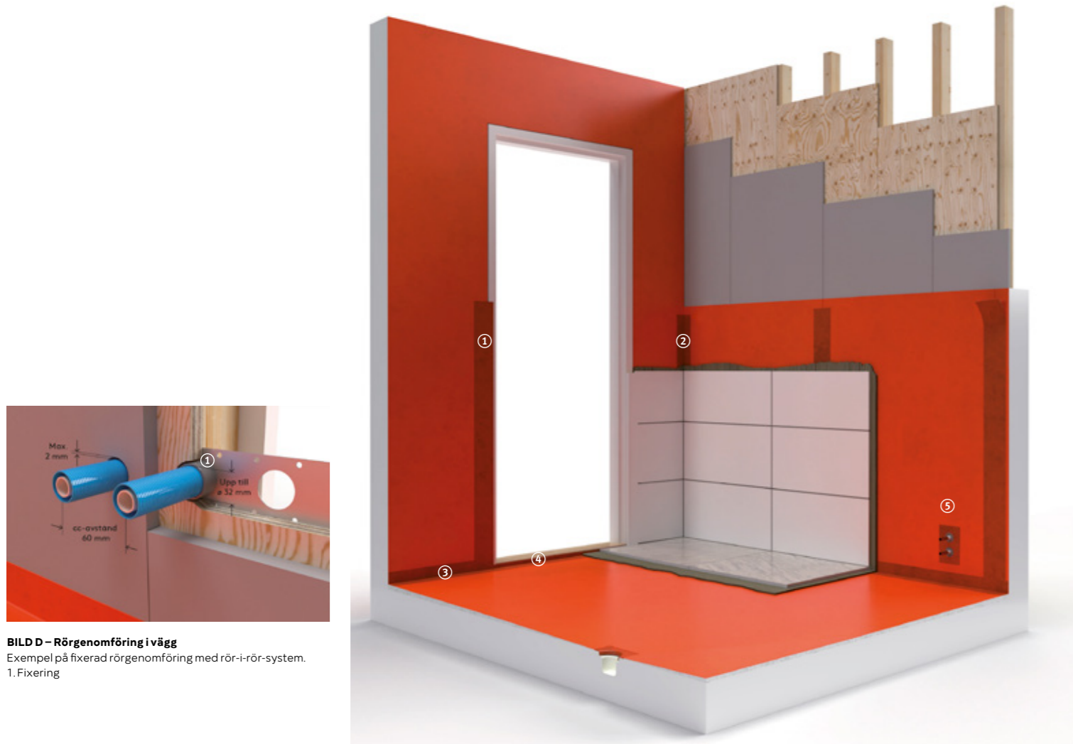
BILD K – Anslutning till plastmatta Anslutningen ska göras med överlapp om minst 30 mm tätskikt ut på plast-mattan bakom keramik. Från golvet upp till nederkant keramik ska det vara minst 80 mm synlig plastmatta.
